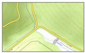
Ausschnitt topografische Karte mit Höhenlinien: der Abfluss erfolgt mit dem Gefälle, senkrecht zu den Höhenlinien. Ist der Abstand der Höhenlinien gering, ist das Gelände steil.
